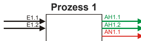
Bild 4-1: Prozessmodell mit Eingangsgrößen (E), Hauptausgangs- (AH) und Nebenausgangsgrößen (AN)
